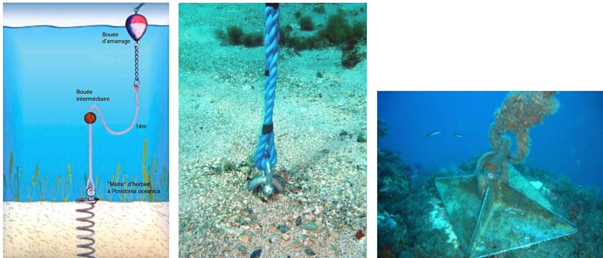
Figure 10 : A gauche, système d'amarrage Harmony® non destructif pour l'herbier, conçu par SMAT Neptune environnement (*in* Boudouresque *et al.*, 2006). Au centre, ancre à vis utilisé par le PMCB pour la zone d'interdiction au mouillage de Méjean. A droite, exemple d'amarrage par une plaque pitonnée dans la roche à Cavalaire (photos : E. Charbonnel/PMCB).
